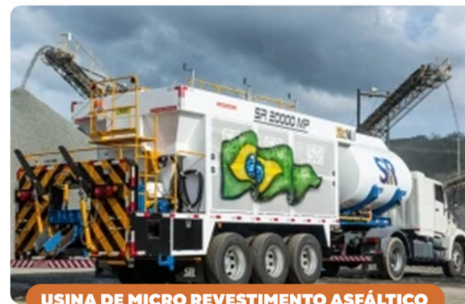
USINA DE MICRO REVESTIMENTO ASFÁLTICO
